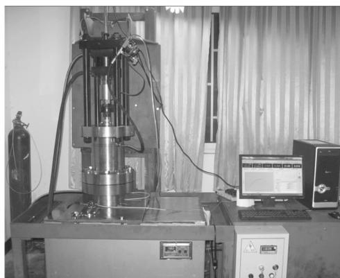
图 1 自压式三轴渗透仪
