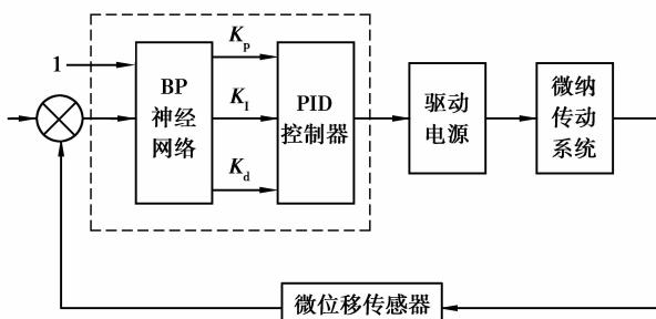
图 8 系统的控制模型
