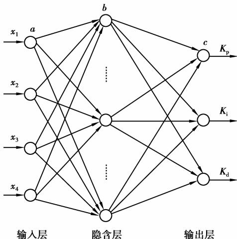
图 9 BPNN-PID 原理
