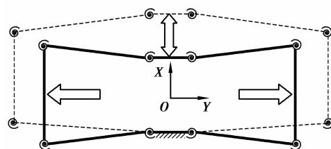
图2 机构放大原理图
