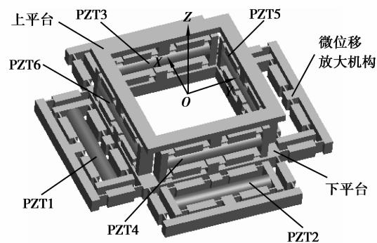
图1 系统结构图
