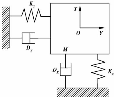
图 3 弹簧-质量-阻尼模型
