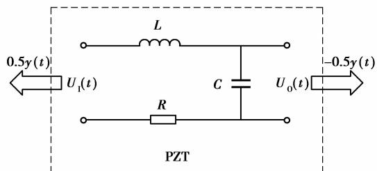
图 5 PZT 的 RLC 电路图
