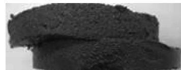
图 9 直接剪切试验后的试件
