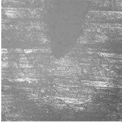
图 9 放电后裂尖宏观形貌
