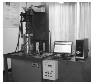
图 2 含瓦斯煤热流固耦合三轴伺服渗流实验装置
