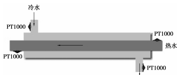
图 4 套管式换热器结构示意图
