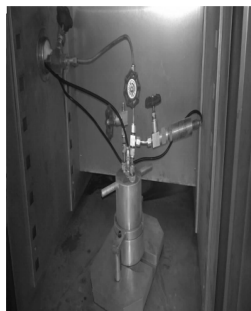
图 3 多功能煤样罐
