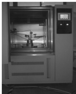
图 2 高低温变频控制系统
