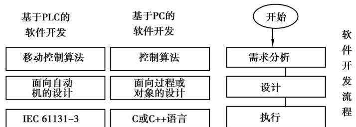
图 5 PLC 软件开发和 PC 机软件开发对比
