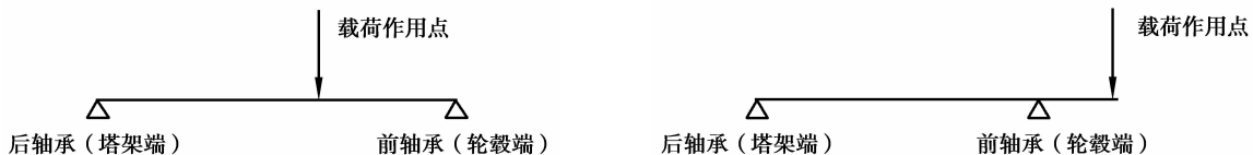
图 4 外圈旋转(风机的载荷作用点位于两个主轴承之间,轴承上的弯矩载荷较小)
