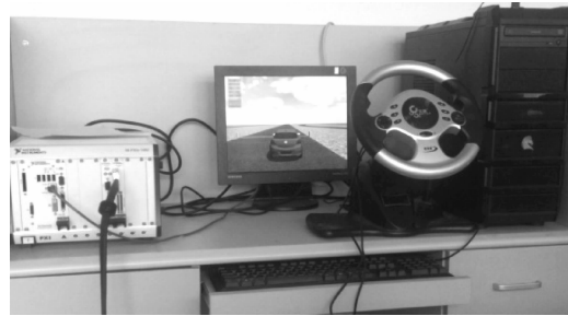
图 13 人在环路模拟驾驶仿真实验系统
