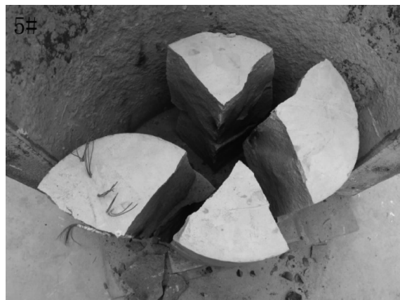
图 3 5# 试块爆破效果图
