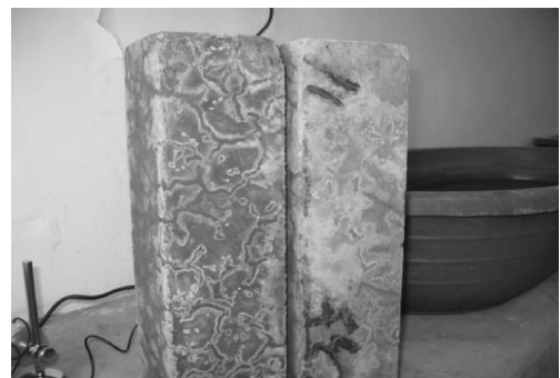
图 4 试验中的混凝土试件 Fig.4 The concrete specimen in the process of test
