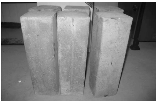
图 3 试验前混凝土试件 Fig.3 Concrete specimen before test
