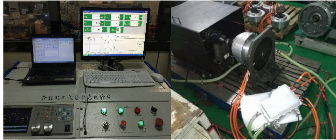
图 7 轮毂电机实验测试平台 Fig.7 Test platform of in-wheel motor
