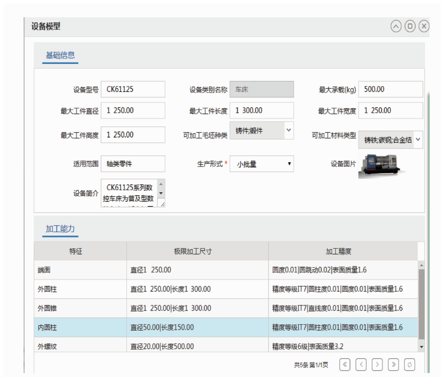
图 6 数控卧车归一化模型
