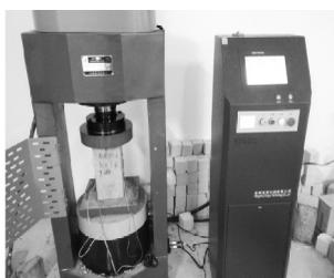
图 3 棱柱体单轴受压应力-应变试验
