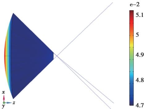
图 2 抛物面碟式接收器射线追踪
