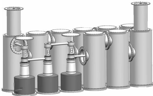
图 2 363 kV 真空断路器单相三维结构
