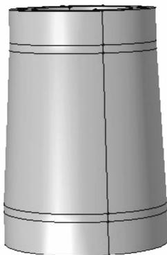
图 14 环氧绝缘支撑台采样线
