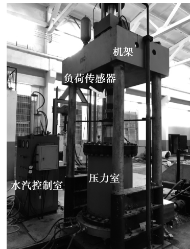
图 2 TAJ-2000 大型动静三轴试验仪
