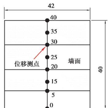
图 10 墙面位移测点位置图(单位:cm)
