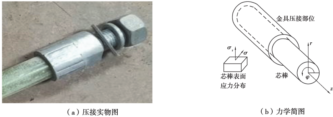
图 1 压接式结构实物图与简图
