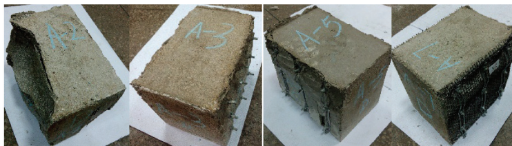
图 6 试样破坏情况
