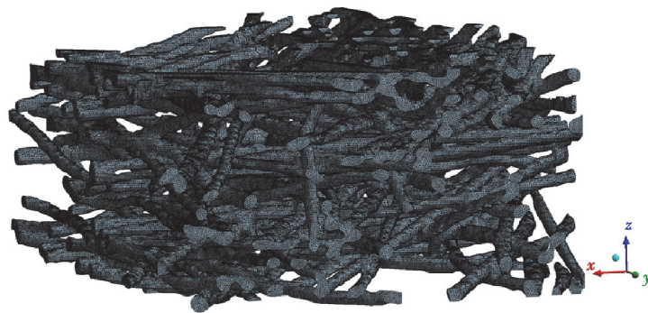
图 4 碳毡有限元网格模型
