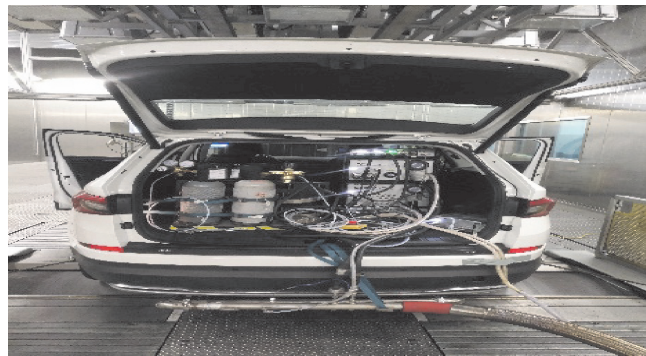
图 2 装有 PEMS 的 RDE 测试车辆
