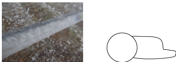
(b) 1号长导线雨凇覆冰中期
