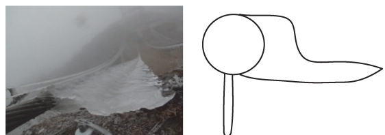
(c) 1号长导线雨凇覆冰后期
