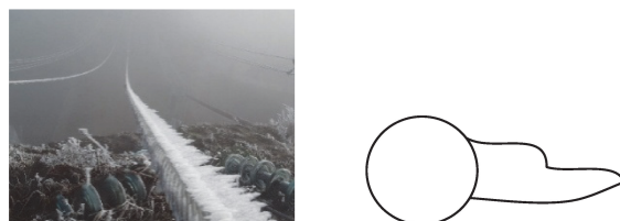
(a) 1号长导线雨凇覆冰初期
