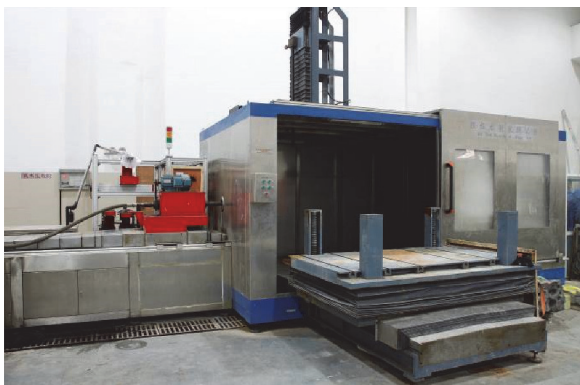
图15 四维水射流试验平台
