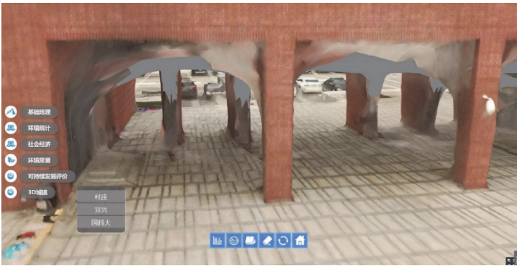
图 9 三维模型中的缺陷
