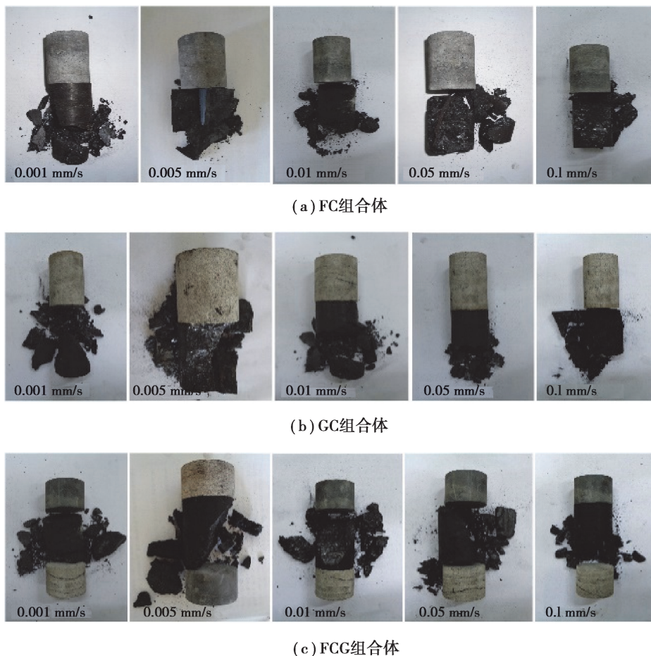
图 3 组合体在不同的加载速率下典型的破坏形态
