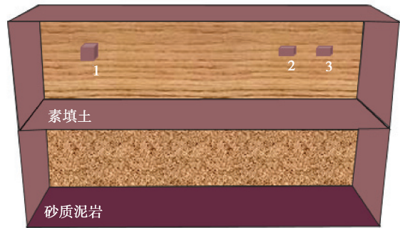
图 7 岩溶和采空区模型试验示意图
