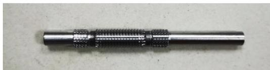
图 1 0.8 mm 螺距滚柱
