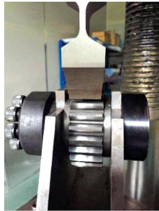
图 7 齿轮加载方式
