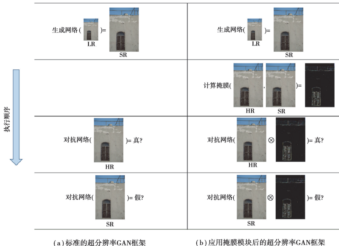
图 3 超分辨率 GAN 框架中集成掩膜模块的流程图
