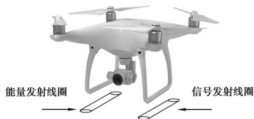
图1 耦合机构安装示意图
