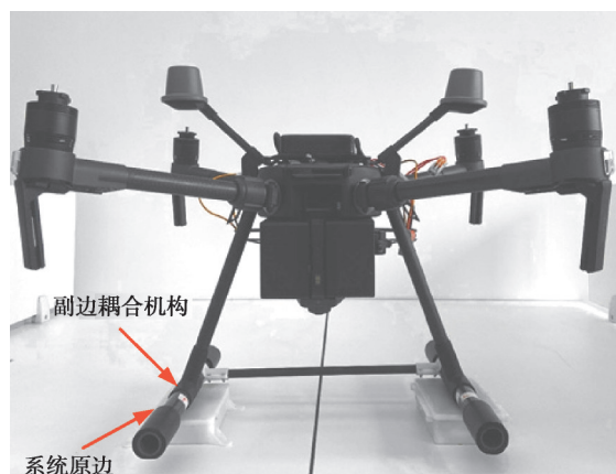
图 13 无人机无线电能传输系统装置
