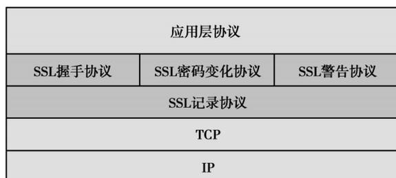
图1 SSL协议位置及构成
