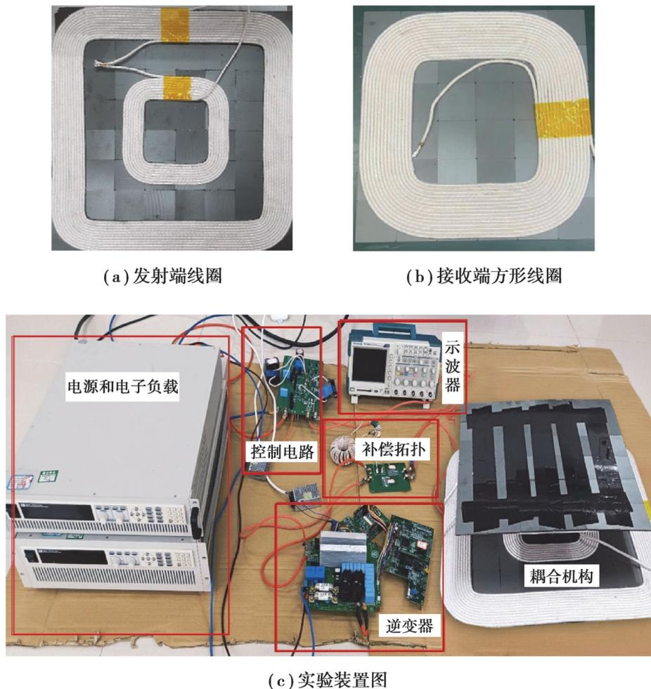
图 18 实验中原、副边线圈及装置图
