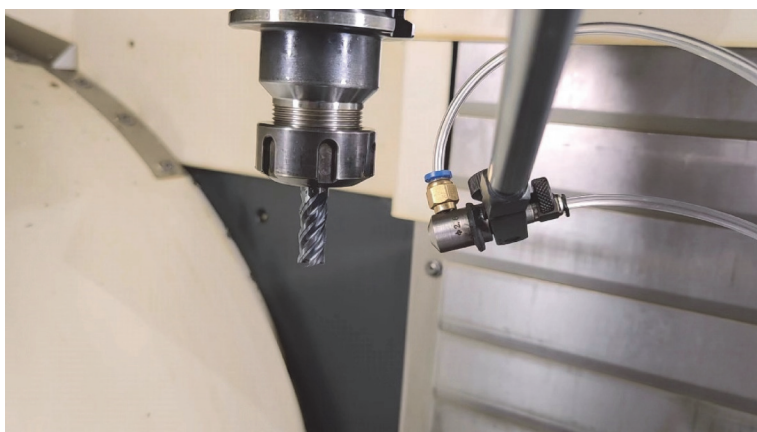
图14 铣削过程中的油水气雾喷射
