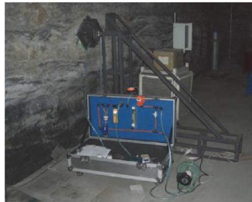
(b) 凝结水测量装置实物图
