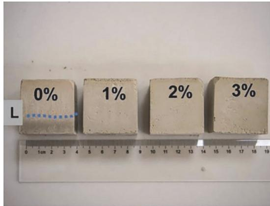
图6 不同掺量MMT内养护NHL2试样的光学照片
