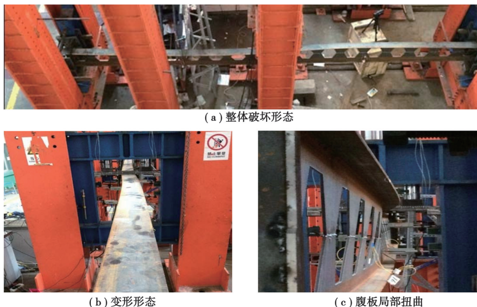
图5 典型试件破坏模式
