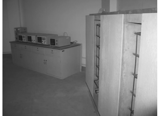
图2 模拟大体积混凝土温度场的试验箱及显示器
