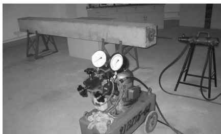
图5 预应力混凝土试验
