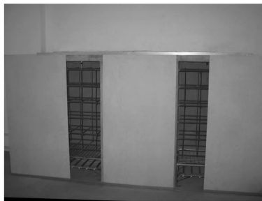
图4 模拟大体积混凝土温度场的混凝土试验箱
