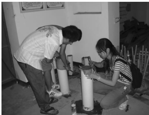
图1 实验桥墩模型制作
