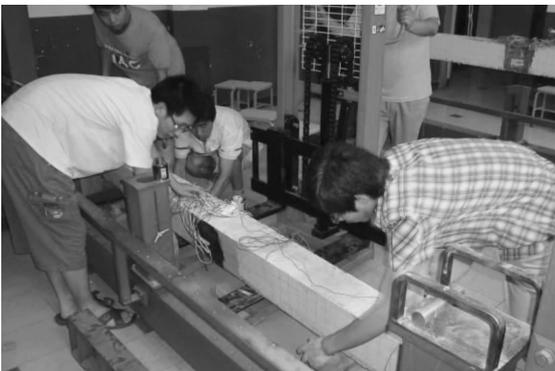
图5 学生进行混凝土梁安装就位
