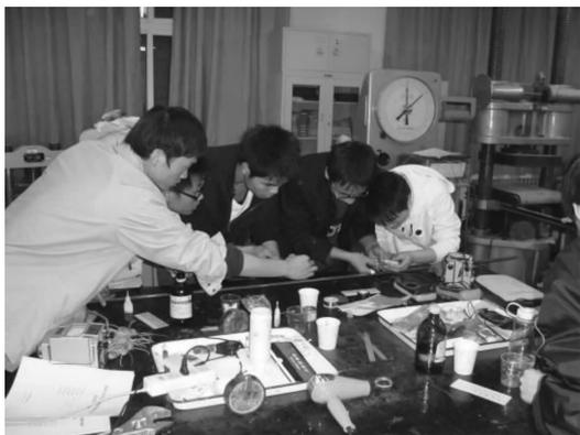
图1 学生粘贴钢筋应变片
