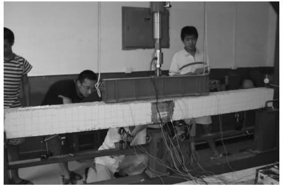
图6 学生进行混凝土梁加载
