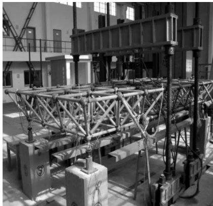
图1 网架结构静载综合型实验
