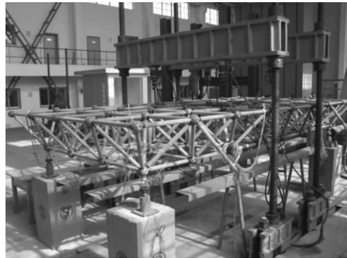
图1 空间网架静载综合型实验
