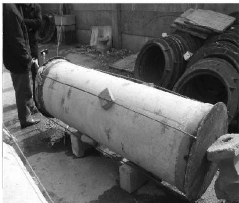
图2 聚丙烯纤维输水管道外压试验
