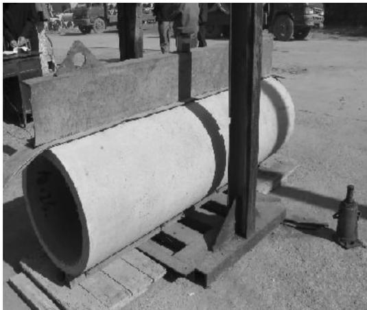
图3 聚丙烯纤维输水管道内水压试验
