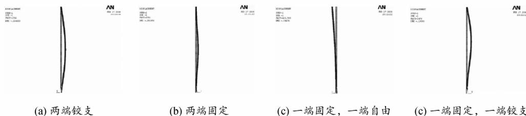
图4 不同杆端约束的压杆屈曲变形
