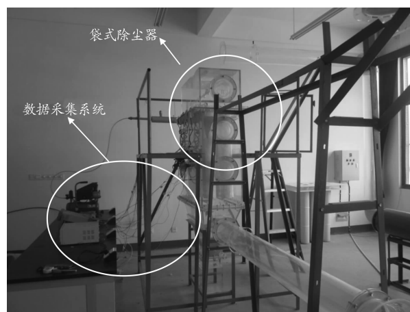
图 3 通风除尘性能测试实验平台
