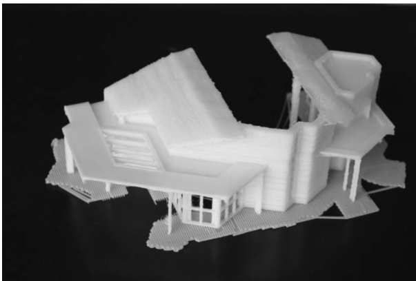
图3 利用三维打印技术输出设计草模对设计方案进行推敲
