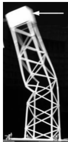
图10 结构模型中受压柱子的稳定性
